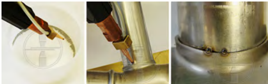
Elektrode (Ø6 mm) mit Ansaugvorrichtung (3)
